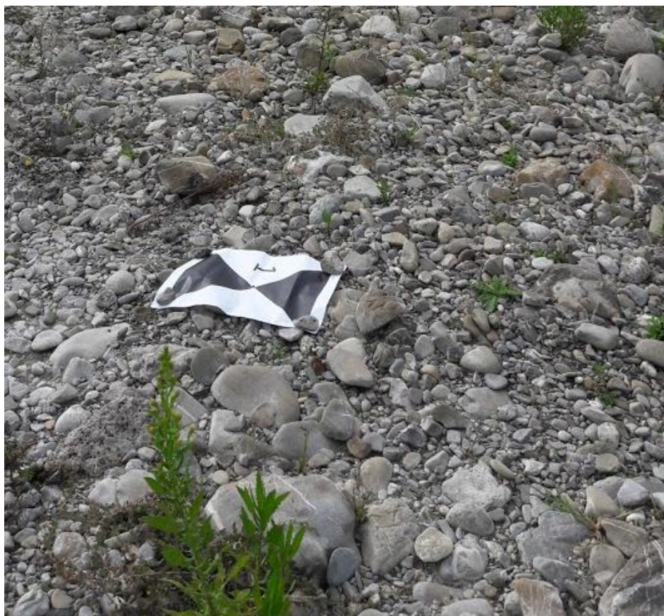
Figura 5 – Esempio di posizionamento di un punto target da rilevare con GPS di precisione.
